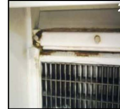
2. Lepas bagian mesin yang dapat dilepas (ikuti petunjuk pabrik) rendam dalam larutan SCALE OFF 1 : 100 dengan air panas (50°C) selama minimal 15 menit. Cuci-Bilas-Sanitasi di bak cuci Double/Triple Sink.
