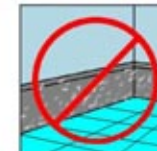
2. Tidak ada percikan dipinggiran lantai.
