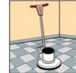
6. Pasang Stripping Pad pada Scrubber Machine lalu lakukanlah Stripping. Bagi dalam ukuran 10'x10'.
